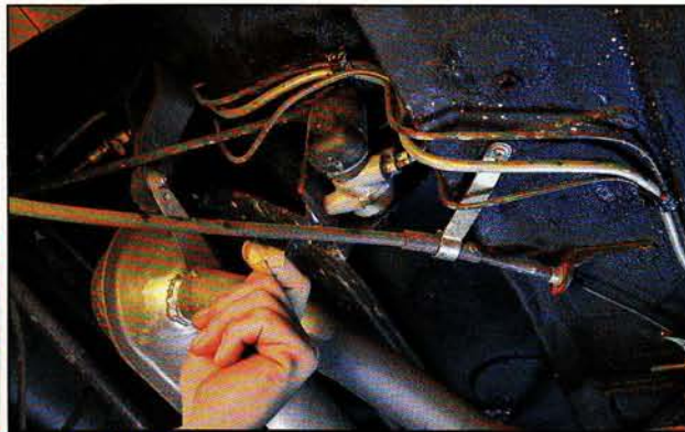
Der Bremskraftregler muss korrekt funktionieren. Haben sich die Federn gesetzt oder wurde der Wagen tiefer gelegt, ist eine Justierung nötig
