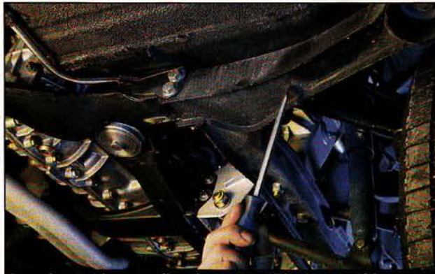
Besondere Beachtung verdient der vordere Hilfsrahmen , auf dem Motor und Getriebe ruhen. Oft sind die Befestigungspunkte marode
