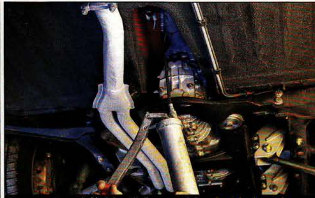
Gern vergessen wird bei den Fünfganggetrieben das Schmieren des Schaltgestänges . Schalthebelgeräusche sind danach verschwunden
